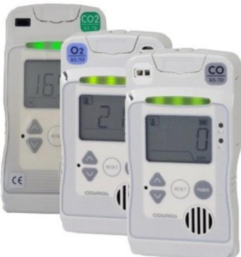
La série des détecteurs fixes KS-7O ( $O_2$ ), KS-7D (CO) & KS-7R ( $CO_2$ ) de New-Cosmos sont des appareils autonomes de détection de gaz avec un afficheur, une alarme visuelle et sonore des relais qui commutent en cas d'alarme ou de défaut d'alimentation ainsi qu'une sortie 4-20mA.
